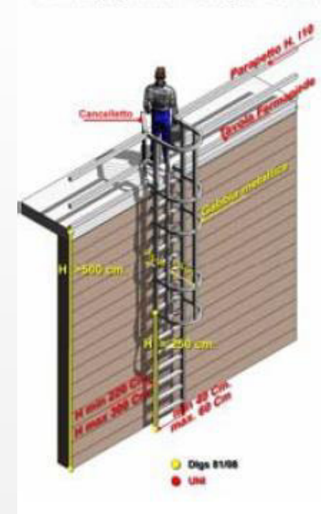
Dimensioni principali delle scale e delle gabbie di sicurezza
