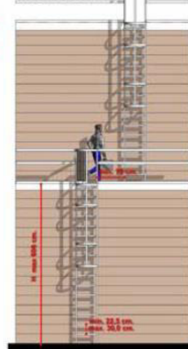
Scala con rampe sfalsate
